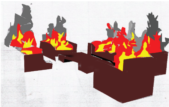
Şekil 8. Sonsuz bir odada oturma odası koltuk takımında - t=415 saniyede tam gelişmiş haldeki yangın için bilgisayar görselleştirmesi [8].
