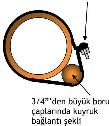
Şekil 2 - Değişik boru çaplarında kuyruk bağlantı şekilleri
