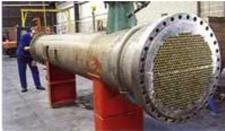
(Şekil-2) Tipik boru kovan (shell and tube) tip soğutucu
