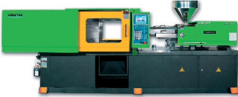
Şekil 3. Örnek bir plastik enjeksiyon makinesi [5]
