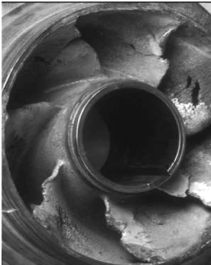
Şekil 5. Kavitasyona uğramış pompa çarkı.
