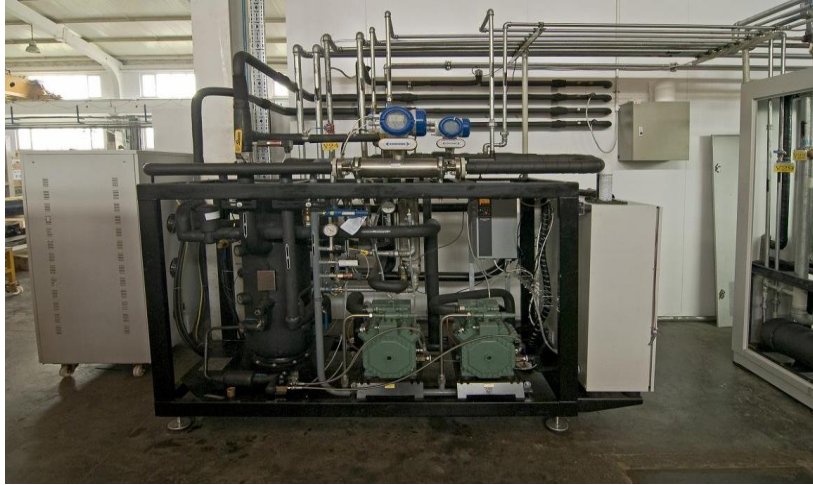
Şekil 24. CO 2 akışkan hazırlama ünitesi [27]
